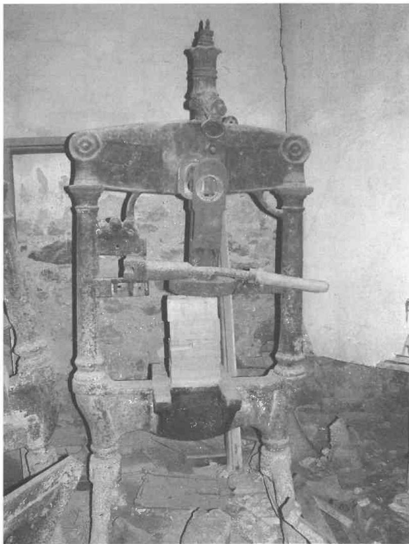
Εικόνα 4: Τυπογραφική μηχανή Hopkinson 1830.
